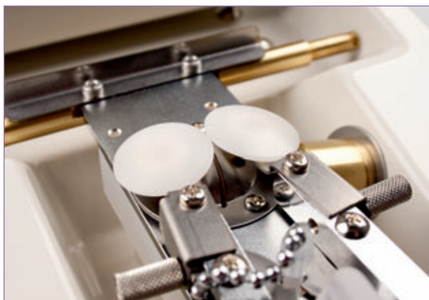
Les deux guidages pour le verre possèdent chacun des roulettes en plastique réglables de façon précise permettant ainsi un positionnement précis au-dessus de la meule de rainurage
