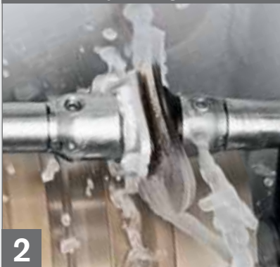
Réaliser le polissage en biseau
